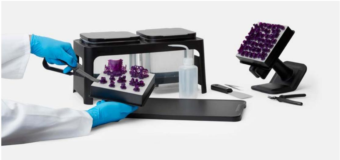
**Hinweis:** Beim Waschen von Castable Wax Teilen verfärbt sich das IPA und Teile, die anschließend darin gewaschen werden, violett. Um zu verhindern, dass sich Teile, die mit anderen Harzen gedruckt wurden, verfärben, waschen Sie Castable Wax Teile in einem eigenen Form Wash oder Finish Kit.
